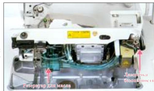
Сконструирована без применения масляного поддона (тип машины с минимальным использованием смазки)
