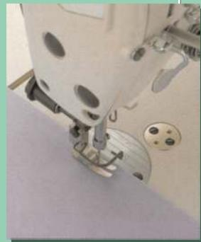
Машина оснащена съемной пластиной для установки приспособлений.
